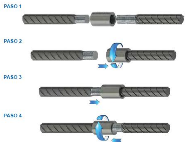
Figura 4. Establecer una conexión de posición de empalmes mecánicos con rosca métrica.
