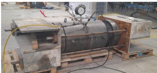
Figura 11. Ensayo de los gatos en las instalaciones de VSL
