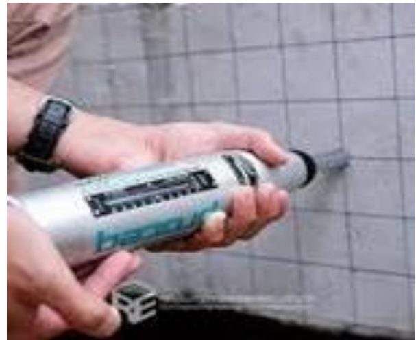
Figura 3. Prueba del martillo Schmidt.
