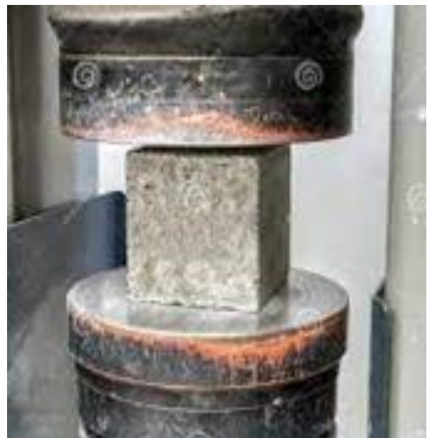
Figure 1. Rotura de probetas por el método tradicional
