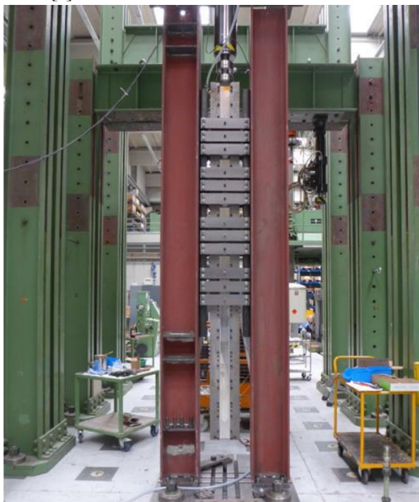
Figura 3. Dispositivo de ensayo de desgaste, con control activo de la temperatura.
