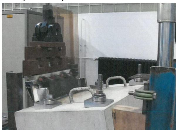
Figura 5. Ensayos de fatiga de detalles de anclaje.
