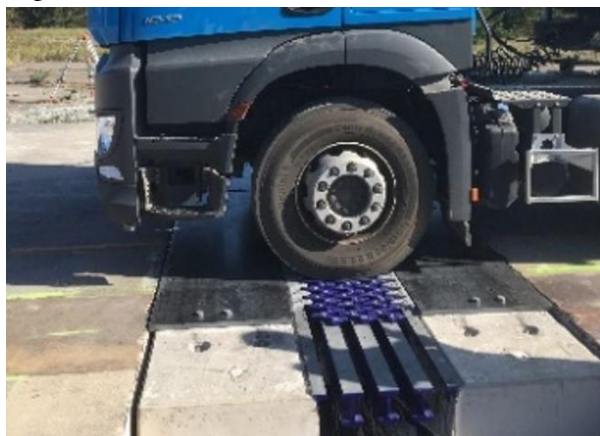
Figura 7. Evaluación dinámica de la junta modular: ensayo complejo que exige experiencia en medición y análisis de datos.
