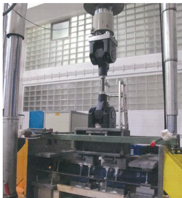
Figura 6. Ensayo de fatiga de un empalme soldado in situ para evaluar la Categoría de Detalle.
