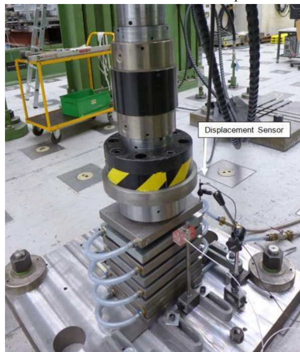
Figura 4. Instalación de ensayo de fatiga. Instalación de ensayo de fatiga con control térmico para evaluar la durabilidad de los componentes deslizantes.
