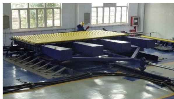
Figura 9. Ensayos de movimiento a escala real de una junta modular de 18 brechas, con combinaciones de desplazamientos longitudinales, transversales y verticales.
