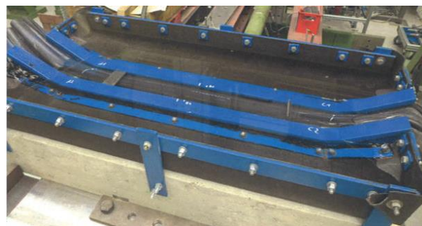
Figura 8. Ensayos de estanqueidad del diseño modular con ciclos repetidos de apertura y cierre.
