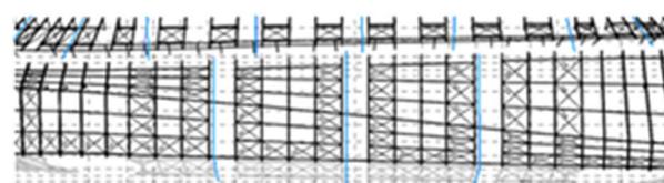
Figura 8. Juntas de dilatación en fachada Oeste
