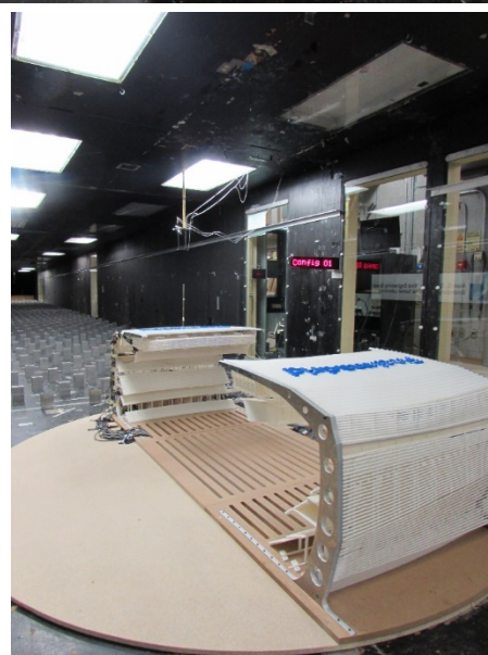
Figura 9. Fotografías del modelo de presiones en túnel de viento de capa límite.
