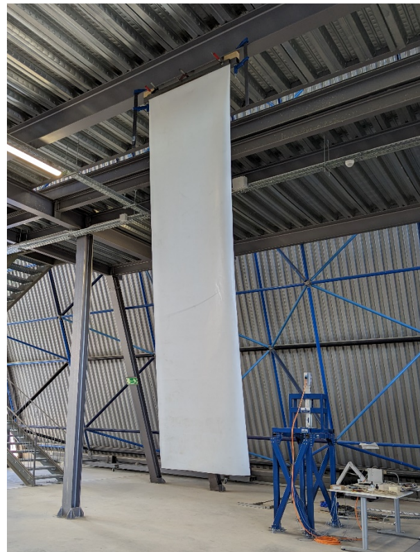
Figura 12. Fotografía de los ensayos de vibración libre en la muestra de 3.5 m x 0.875 m.
