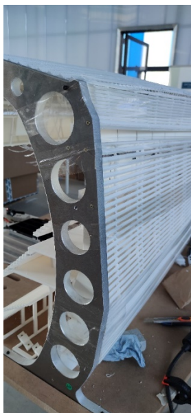
Figura 7. Detalle de una “costilla” para sustentación del modelo.
