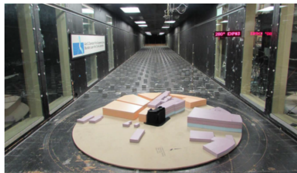
Figura 4. Ensayos en túnel de viento de capa límite del museo Doctora Leila Mezian (Casablanca).
