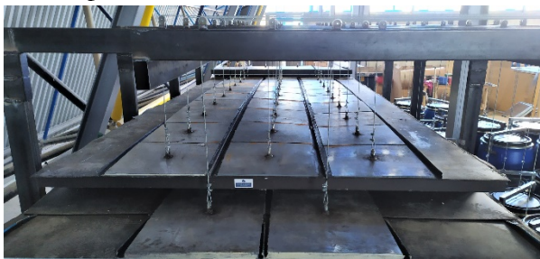
Figura 15. Fotografía de la muestra con una carga aplicada de 3.5 kPa. Oritia&Boreas LACIAD
