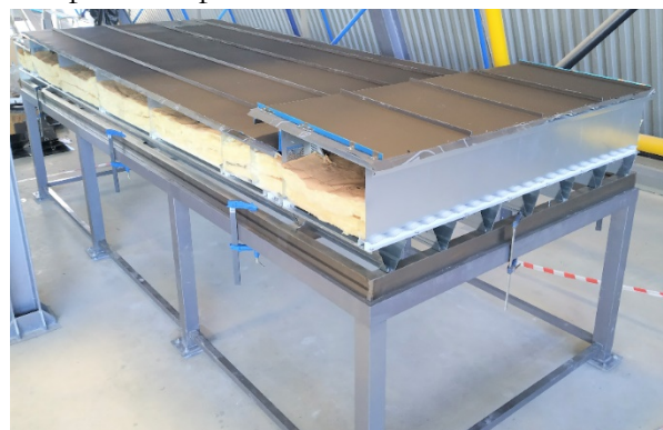
Figura 5. Fotografía de la muestra de fachada a escala real situada sobre el banco de ensayos desarrollado. Oritia & Boreas.
