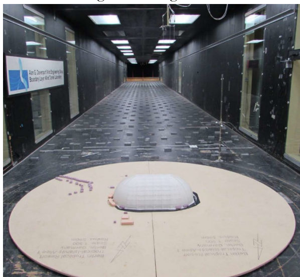
Figura 3. Modelo de presiones en túnel de viento de capa límite. Oritia&Boreas
