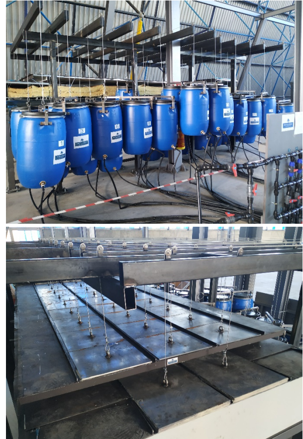
Figura 9. Sistema de aplicación de la carga de succión. Puente de carga Oritia&Boreas LACIAD
