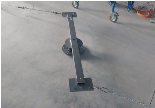
Figura 9. Fotografía del prototipo de TMD tomada durante la ejecución de los ensayos.
