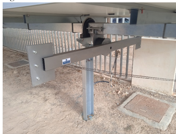
Figura 10. Fotografía de prototipo de TMD montado sobre seguidor solar, vista frontal de detalle.
