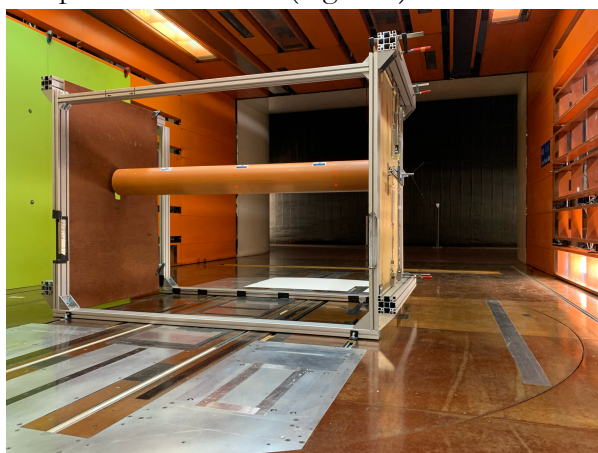
Figura 7. Ensayo seccional en túnel de viento de péndolas para la determinación de necesidades de disipación específicas y verificación de soluciones aerodinámicas.
