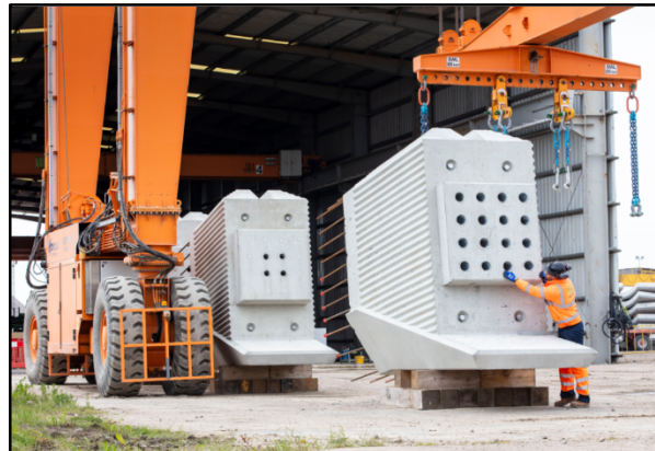
Fig. 10. Prefabricación de fustes en planta (TVV).
