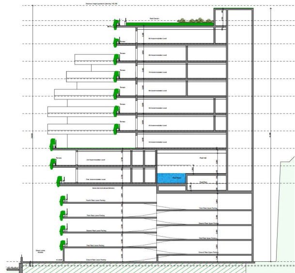
Figura 5. Sección edificio norte
