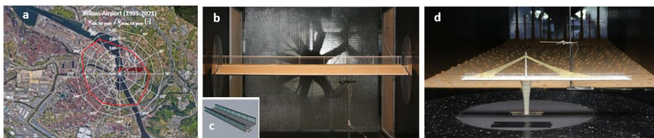
Figura 9. a) vientos dominantes; b): modelo seccional a escala 1/20 en túnel de viento; c) esquema del modelo seccional; d) modelo aeroelástico de parte móvil a escala 1/20 en el túnel de viento
