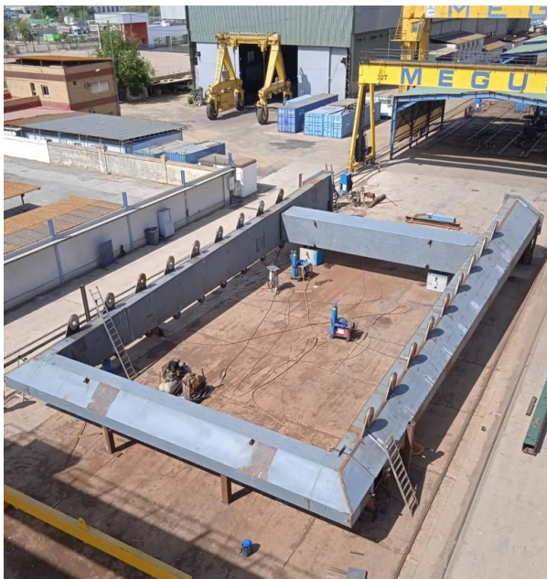
Figura 16. Montaje en blanco de mástil en taller.
