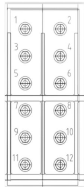
Figura 9: Alzado de placa de conexión con numeración de los taladros/barras
