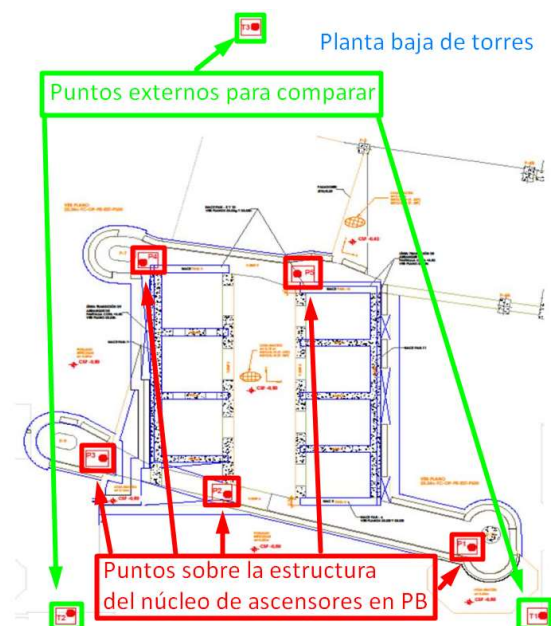
Figura 13: Puntos de control de asentamiento del núcleo de ascensores
