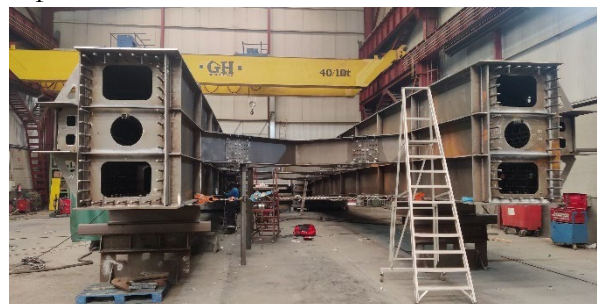
Figura 6. Fotografía de la sección del arco en taller
