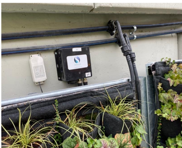
Figura 8. A la izquierda dispositivo con los sensores de HR y Tª y a la derecha el que contiene los sensores de corrosión.
