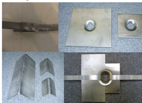
Figura 1. Sistema de refuerzo CAM. Detalle de bandas y pletinas
