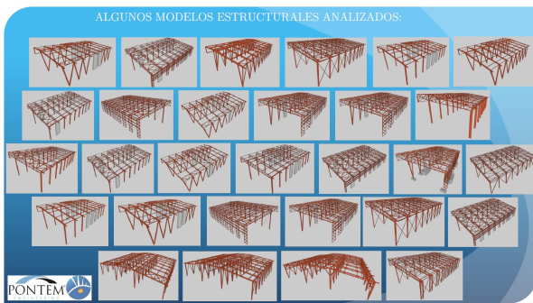
Figura 14. Algunos ejemplos de modelos estructurales predimensionados.
