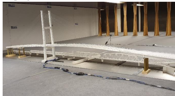
Figura 10. Modelo a escala 1:150 en túnel de viento
