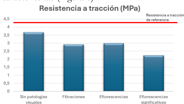
Figura 6. Correlación ensayos resistencia a tracción y patologías existentes.
