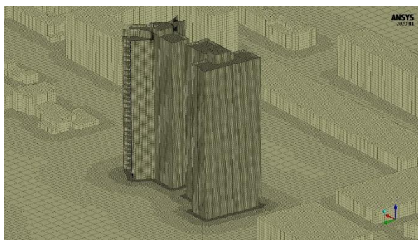
Figura 13. Mallado de la simulación. Detalle de las torres.
