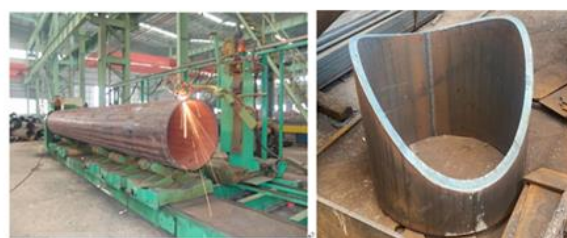
Figura 7. Corte CNC y producto acabado
