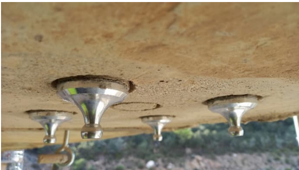
Figura 26. Dowels para ensayo de pull-off.
