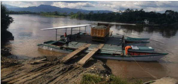
Figura 1. Transporte mediante barcaza de un volquete entre ambas márgenes del río Huallaga.
