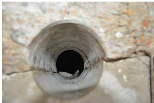
Figura 8. Testigos en la interfaz de la junta fría del vano 3
