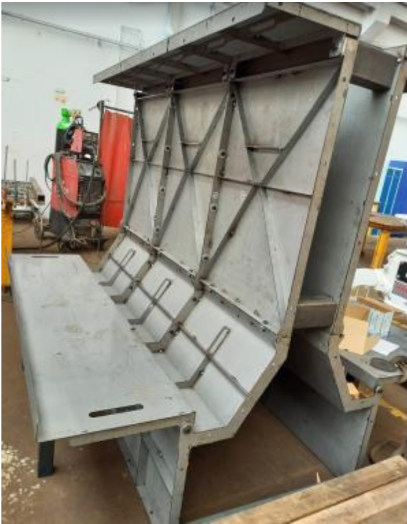
Figura 22. Módulo de encofrado metálico fabricado con la forma de la nueva viga
