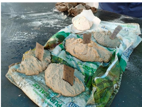
Figura 23. Pruebas de pigmentación en mortero
