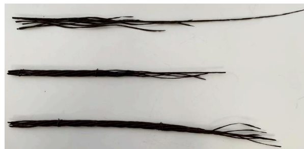
Figura 12. Muestras de los cordones rotos, en la zona de rotura (derecha) y en una zona menos dañada (foto del Laboratorio de Ciencia de Materiales).
