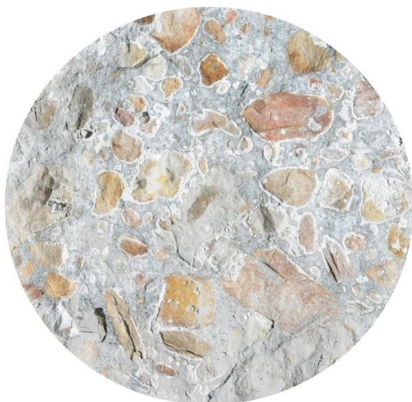
Figura 20. Probeta con aureolas de gel en la interfaz árido-pasta. Foto Laboratorio de Química [6] de la Escuela de Ing. de Caminos, C. y P. de Madrid.
