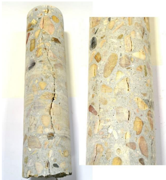
Figura 18. Fisuras longitudinales en testigos. Foto cortesía del Laboratorio de Química de la Escuela de Ingenieros de Caminos, C. y P. de Madrid.
