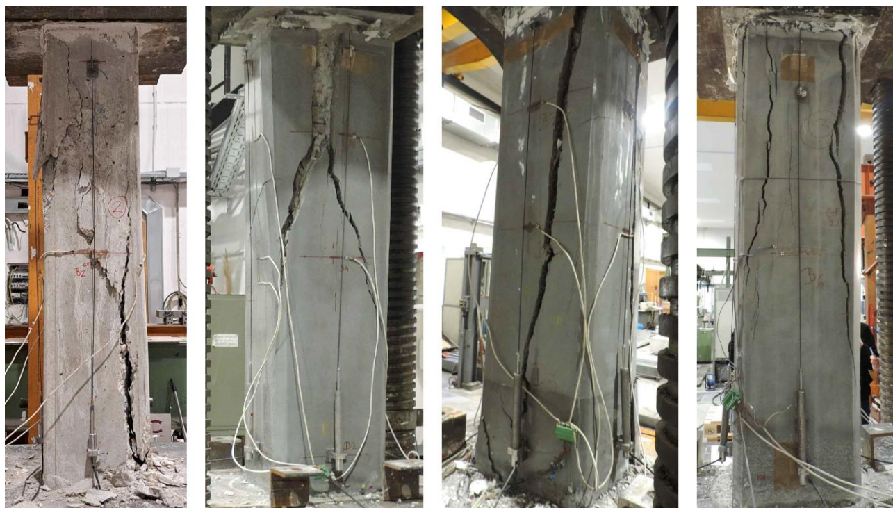
Figura 7. Rotura de los pilares cuadrados tras el ensayo: de izquierda a derecha S0, S1, S2 y S3.
