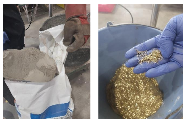
Figura 2. Mortero de altas prestaciones: Polvo de mortero y fibras de acero.
