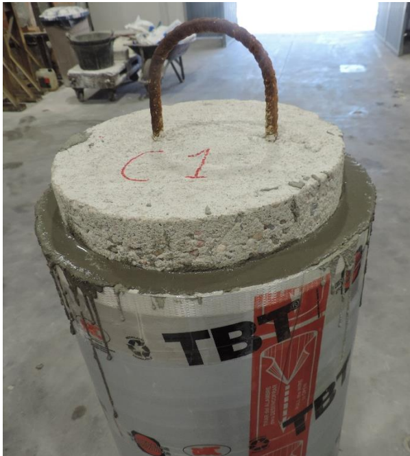
Figura 3. Ejecución del refuerzo hasta una altura inicial de 1150 mm.
