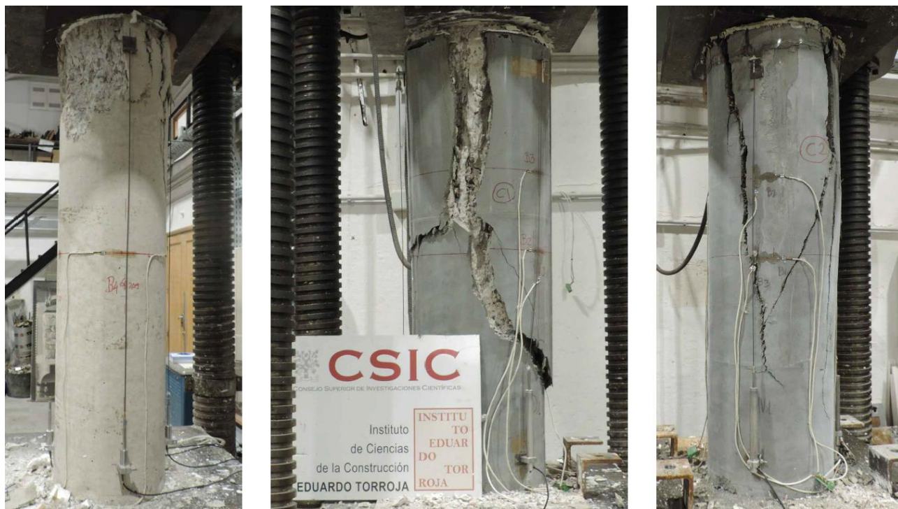
Figura 6. Rotura de los pilares circulares tras el ensayo: de izquierda a derecha C0, C1, C2.
