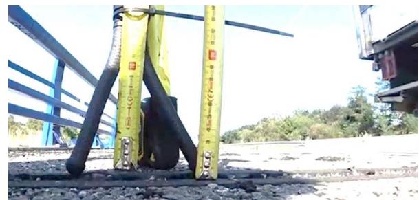
Figura 16. Flecha dinámica medida durante una inspección visual al paso de un vehículo con eje tándem del orden de 5mm.
