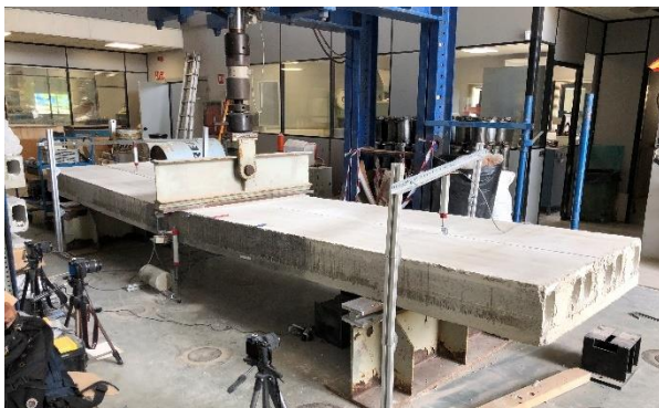
Figura 4. Instrumentación instalada en el ensayo.
