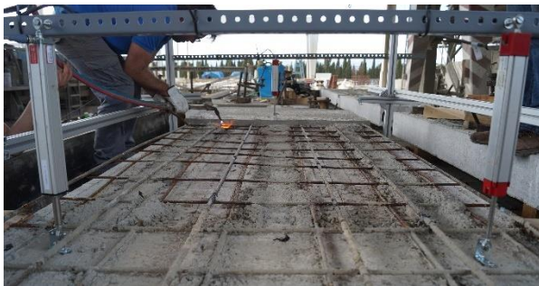
Figura 3. Instrumentación dispuesta durante la activación del espécimen.
