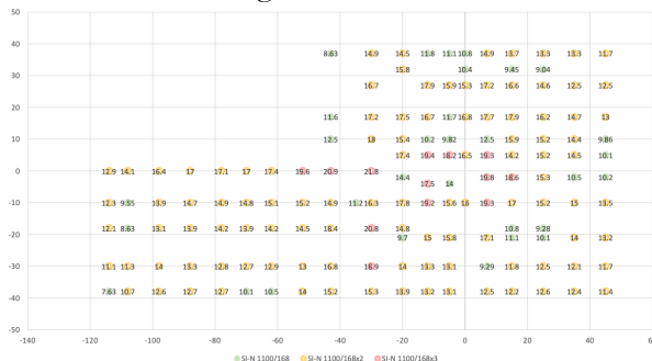
Figura 3. Disposición esquemática en planta de los aisladores sísmicos.
