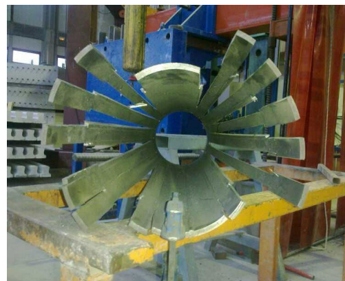
Figura 3. Corte de probetas a partir de tubos de acero estructural S355.
