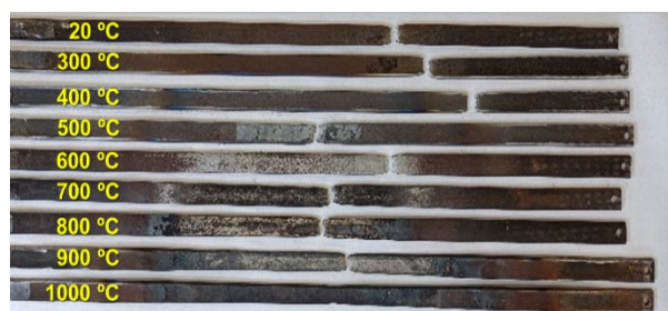
Figura 9. Aspecto de las probetas de acero S355 tras los ensayos post-fuego.
