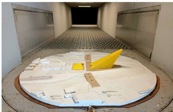
Figura 11. Modelo para ensayo en túnel de viento
