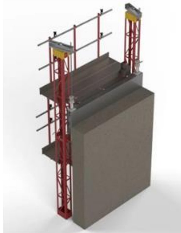
Figura 2. Esquema de encofrado deslizante a una cara.
