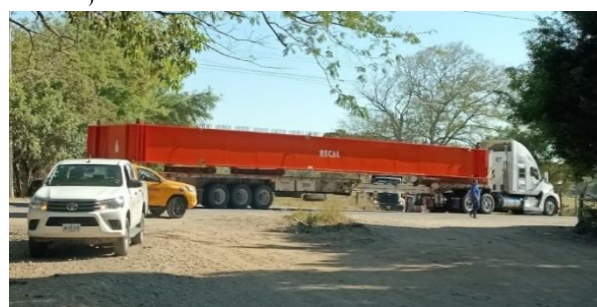
Figura 9. Transporte de vano completo
