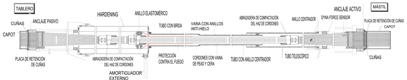
Figura 9. Esquema elementos del tirante
