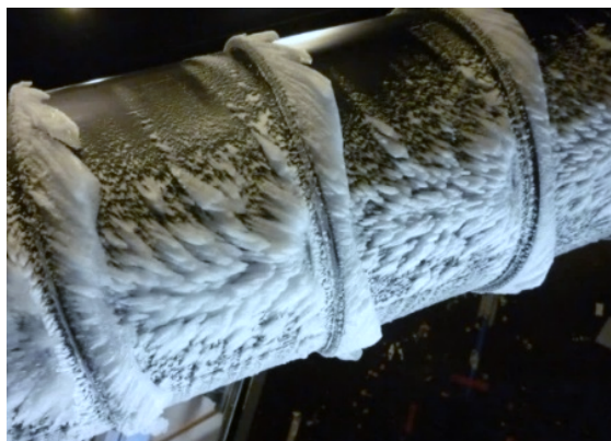
Figura 4. Detalle vaina global con anillos antihielo
