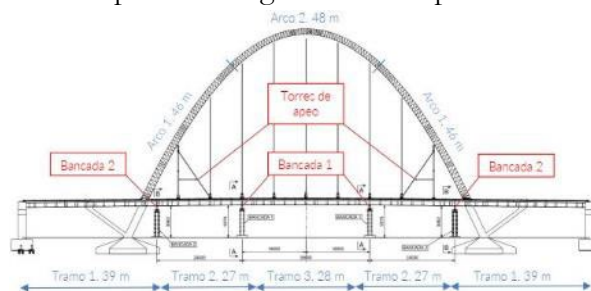
Figura 17. Tramos de montaje
