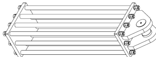
Figura 10. Vista en perspectiva de un elemento de anclaje (Maurer)
