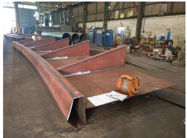
Figura 18. Pieza de costillas transversales, chapa de acera y viga de borde
