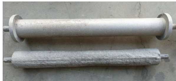
Figura 13. Diferencia de estado de rodillos después de ser chorreados
