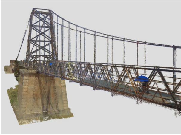
Figura 4. Nube de puntos de la pasarela de Pajareles.
