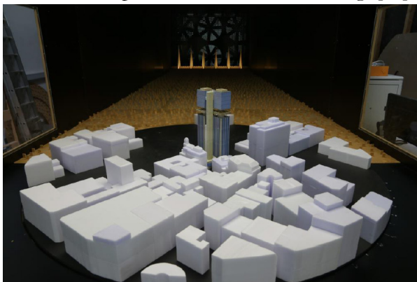
Figura 10. Imagen del ensayo en túnel de viento
