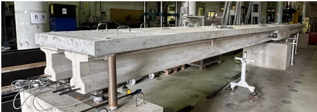
Figura 1. Vista del tablero continuo de dos vanos con armadura pretesa de FRP justo después de construcción.
