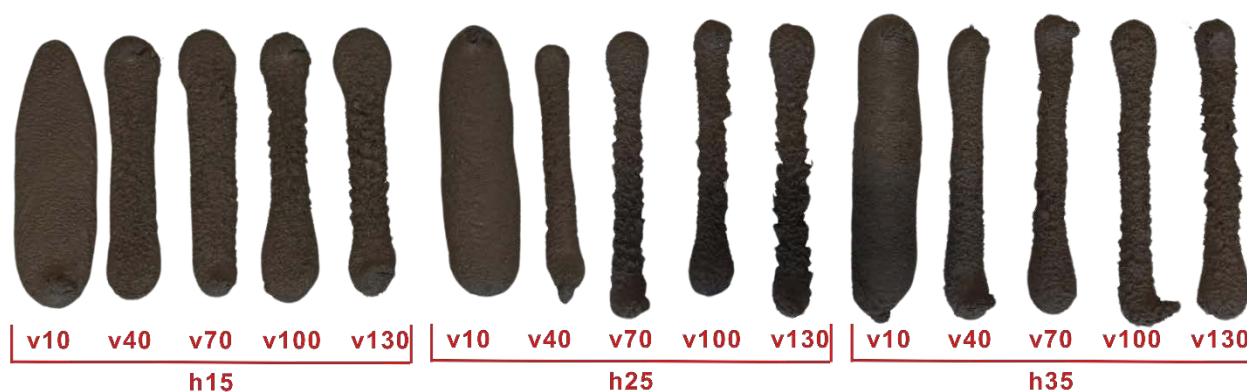
Figura 4. Muestras impresas analizar la capacidad de extrusión a una edad V10, V40, V70, V100 y V130 representan las velocidades de impresión (mm/s) y h15, h25 y h35 corresponden a las alturas de capa (mm).
