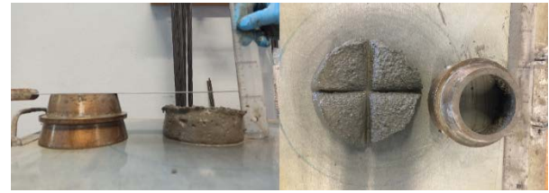
Figura 3. Ensayo de mini-slump para analizar la evolución de la fluidez
