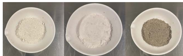
Figura 1. De izquierda a derecha: filler calizo (LF), metacaolín (MK) y ceniza de biomasa (BA)
