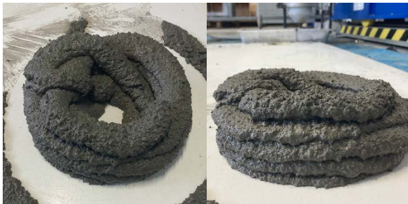
Figura 10. Cilindro fallido mezcla SUST con diámetro 250mm
