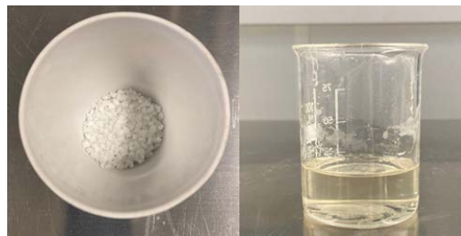
Figura 2. De izquierda a derecha: sulfato de aluminio (AS) y superplastificante, Sika ViscoCrete-90NG
