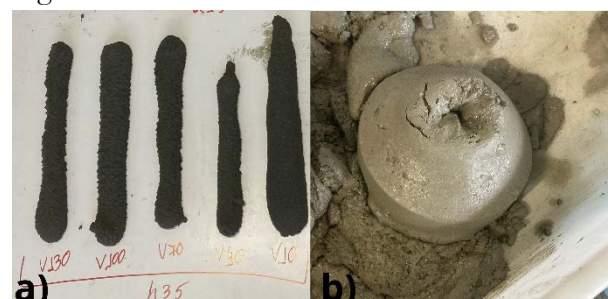
Figura 7. a) Resultados obtenidos con la mezcla REF a los 100 minutos; b) Bloqueo de la boquilla con la mezcla SOST a los 80 minutos.
