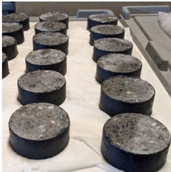
Figura 4. Discos de hormigón preparados para el ensayo de fisuración.
