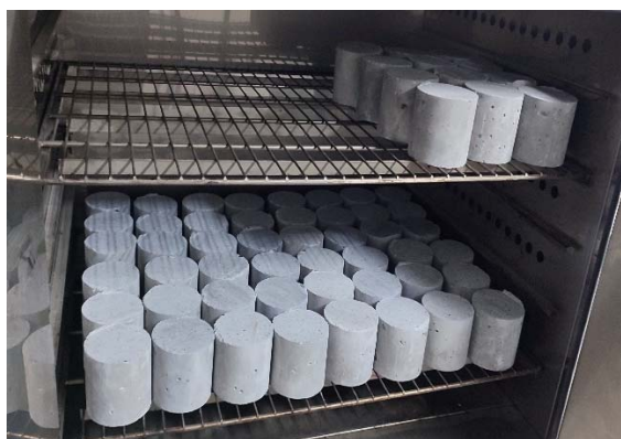
Figura 2. Probetas empleadas en ensayo de capilaridad
