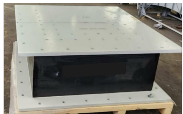
Figura 14. Aislador terminado y ensayado.
