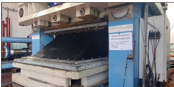
Figura 15. Ensayo de prototipo T1 de MCE hasta desplazamiento d_{max} = 633 mm.
