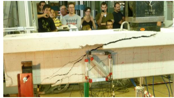
Figura 2. Rotura por cortante con losa fisurada.
